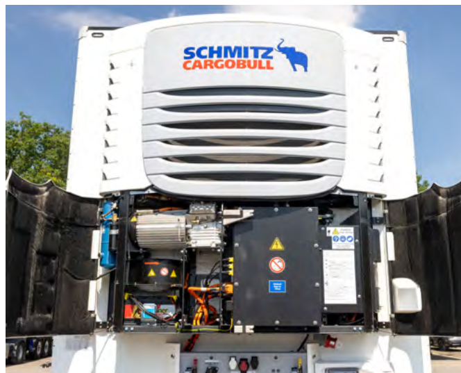
S.CU ep85 w pełni elektryczny agregat o dużej wydajności dający możliwość zastosowania w dzielonych przestrzeniach ładowni.
