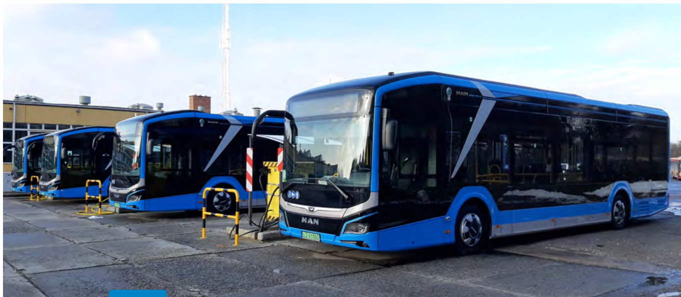
Energia w autobusach jest uzupełniana podczas postoju w zajezdni. Zajmują się tym pracownicy bazy, ale kierowcy również są przeszkoleni z obsługi ładowarek.
