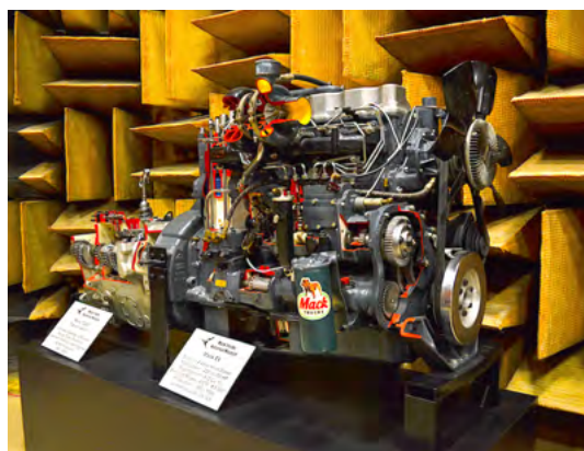
Niezwykle popularny, 11-litrowy silnik Mack E6 w wersji z czterema zaworami na cylinder.
