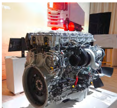
Najnowszy silnik wysokoprężny Scanii, 5-cylindrowy Super 11. Ma dwa wałki rozrządu w głowicy (DOHC) i zmienne fazy rozrządu (VVT), a tłumienie drgań wspomaga również układ umożliwiający indywidualne regulowanie porcji paliwa wtryskiwanej do poszczególnych cylindrów, odpowiednio do chwilowych warunków pracy silnika.
