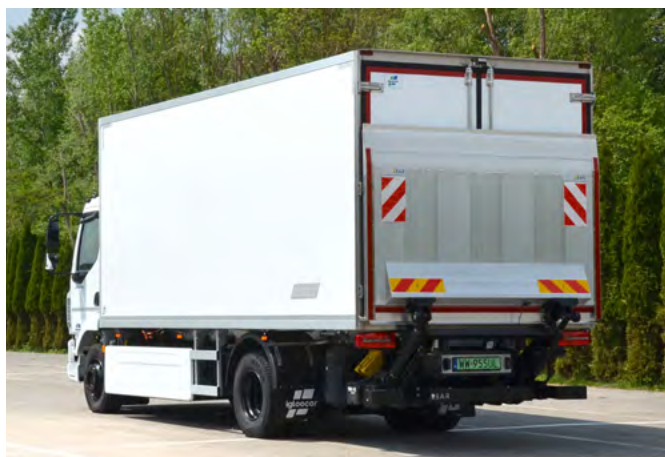
Szesnastonowy XB z rozstawem osi 4,5 m jest zwartym i zwrotnym pojazdem, którym łatwo manewrować.
