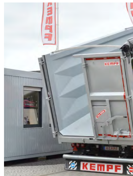
Kempf używa w swoich naczepach do recyklingu stali o twardości 450 HB.
