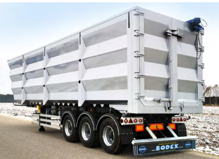
Naczepa do złomu firmy Borex z charakterystycznym wzmocnieniem ścian.
