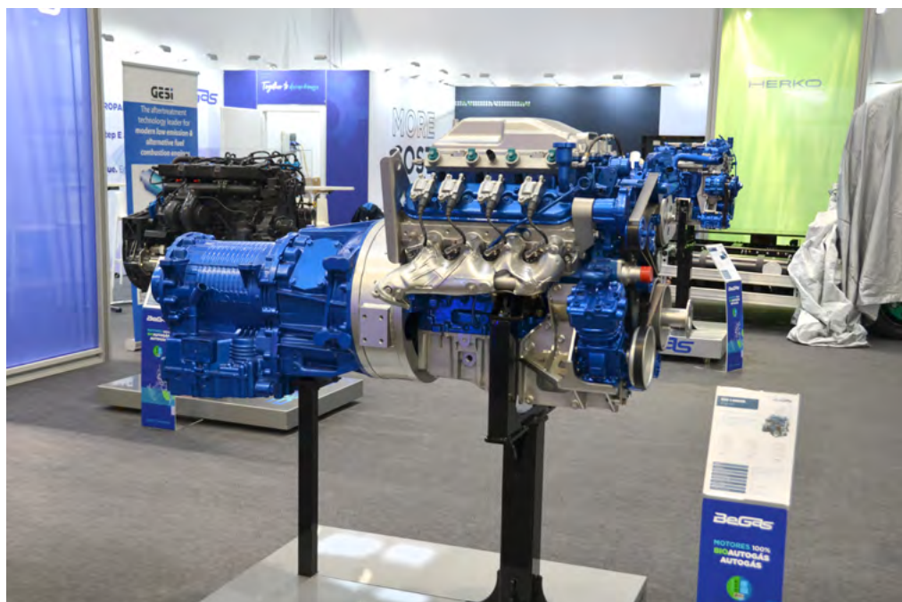
LPG wróci tylnymi drzwiami jako bioLPG? Ten silnik na biopropan został zaprezentowany przez spółkę BeGas na targach IAA w 2024 roku. Jest zgodny z Euro VI E i dostępny w wersjach o mocy 250, 280 i 320 KM.
