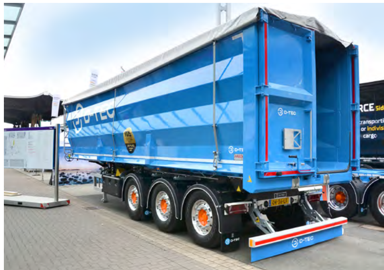
D-Tec zastosował w swojej naczepie stal Hardox. Podłogę wykonano z blachy o grubości 5 mm, a ściany z 3-milimetrowej.
