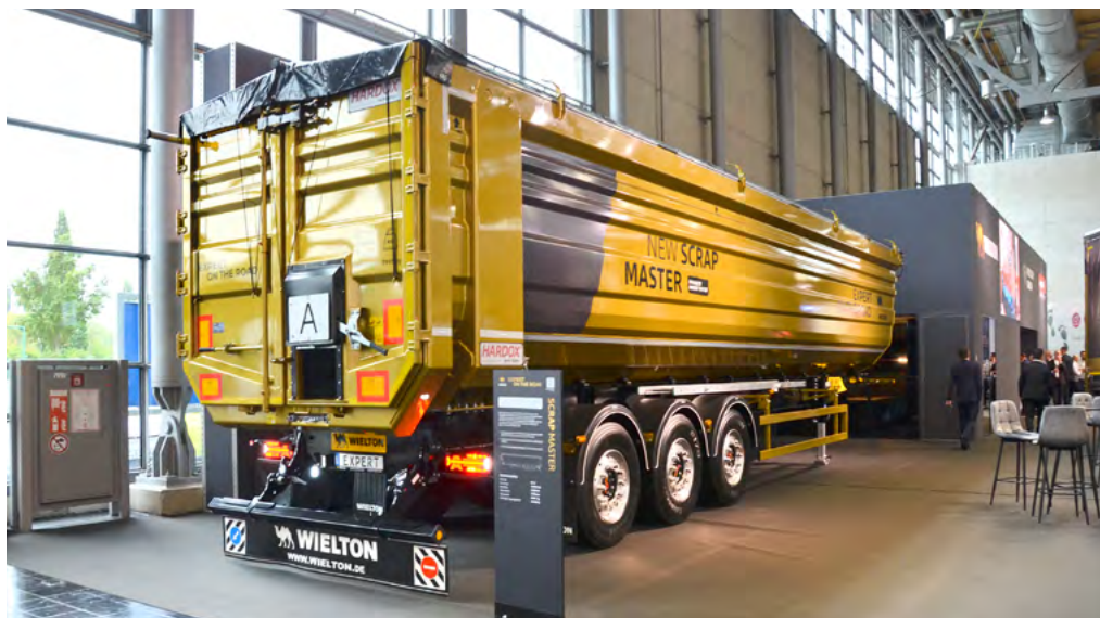
Naczepa Scrap Master firmy Wielton ze skrzynią o objętości 62 m 3 . Dzięki zastosowaniu stali Hardox 500 Tuf jej masa własna wynosi tylko 8995 kg.
