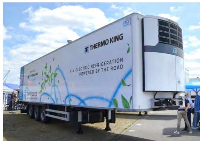
Testowa naczepa Chereau z hybrydowym agregatem Thermo King i systemem AxlePower to wydajny, ekologiczny pojazd, który może okazać się przydatny np. w ciężkiej dystrybucji.
