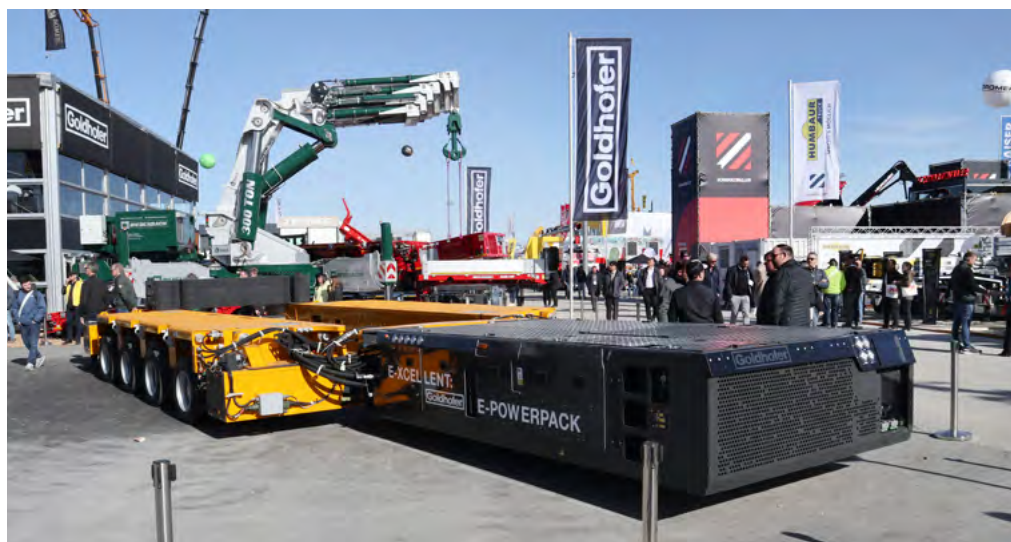
Moduł samobieźny Goldhofer PST/SL-E z hydraulicznym poszerzeniem i elektrycznym napędem E-Power Pack zapewnia dużą stabilność ładunkom z wysoko położonym środkiem ciężkości. Moc napędu elektrycznego wynosi 340 KM.
