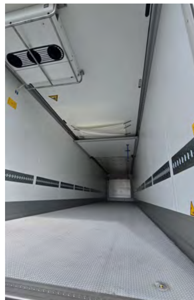
Wielotemperaturowa naczepa chłodnia umożliwia jednocześnie przewóz produktów wymagających różnej temperatury podczas transportu. Coraz więcej takich naczep pojawia się we flocie FM Logistic.
