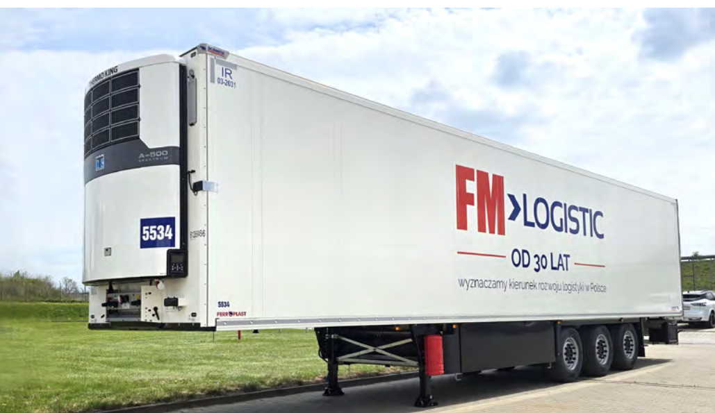
Chłodnia Schmitz SKO 24/L – 13.4 FP z agregatem Thermo King A 500 Spectrum, który na postoju może być zasilany prądem bezpośrednio z gniazdka.
