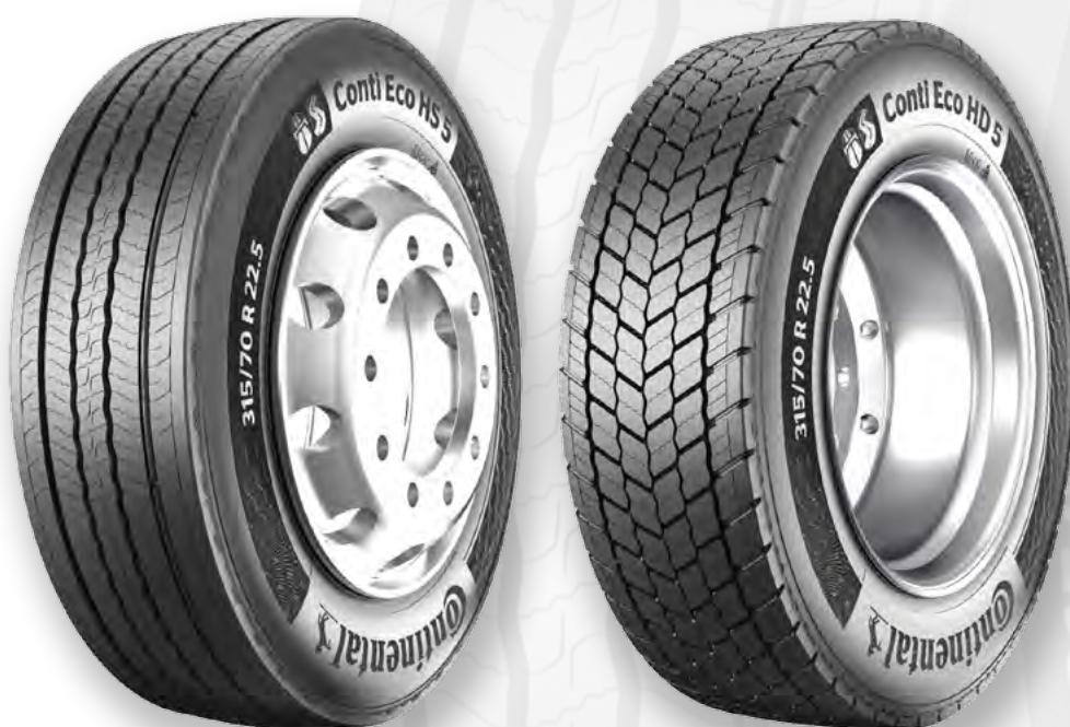
Opony nowej generacji Conti Eco HS5 na oś kierowaną i Conti Eco HD5 na napędową.
