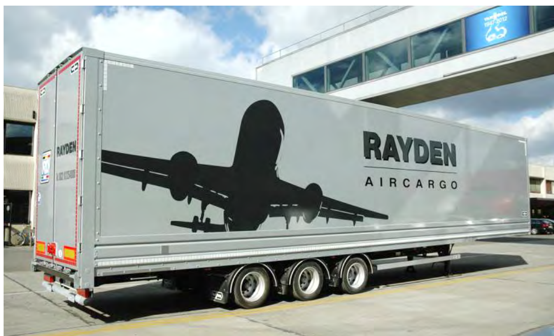
Naczepa lotnicza Van Hool. Stosunkowo małe koła ułatwiają zwiększenie użytecznej wysokości zabudowy furgonowej.
