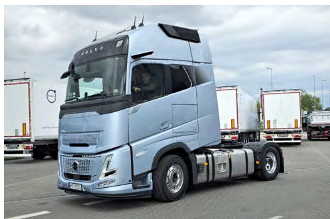
Wydłużona o 25 cm kabina XXL Volvo Aero, może teraz współpracować z naczepami o typowej w Europie długości, tworząc zgodnie z przepisami zwykłe zestawy. Stawarza to nowe możliwości i podnosi komfort odpoczynku kierowcy. Dzięki temu leżanka może mieć szerokość 106 cm.
