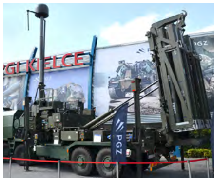
Podwozie Jelcza 8x8 z wyrzutnią iLauncher, będącą częścią systemu obrony powietrznej Mała Narew.
