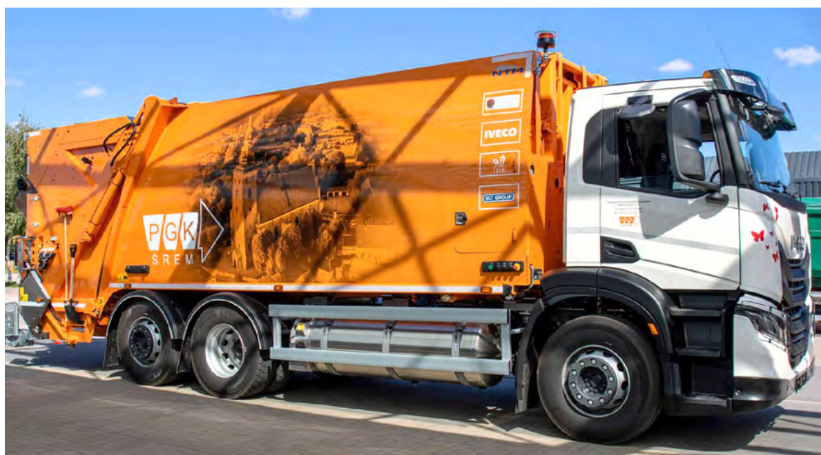
Śmieciarka na podwoziu IVECO S-Way napędzana silnikiem Cursor 9 o mocy 340 KM zasilanym LNG.
