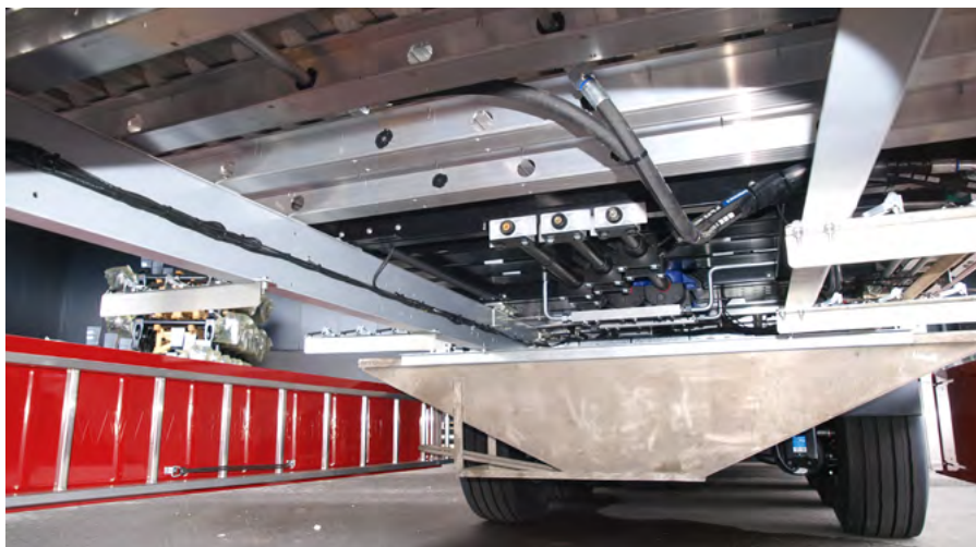
Siłowniki hydrauliczne wprawiające w ruch profile tworzące ruchomą podłogę. Wydajność układu hydraulicznego wpływa na szybkość rozładunku.
