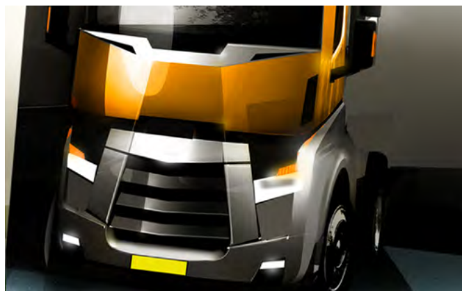
Jedna ze śmiałych, wstępnych propozycji. Wyraźnie widoczne są linie, które zdefiniowały sylwetkę gamy T. Kabina ma formę pionowego klina, zmniejszającą opór powietrza.
