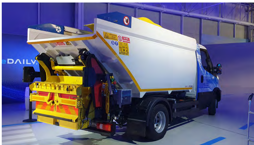
Kompaktowa, elektryczna śmieciarka na podwoziu eDaily. Zasilanie różnorodnych zabudów utatwiają dostępne opcjonalnie przystawki odbioru mocy.
