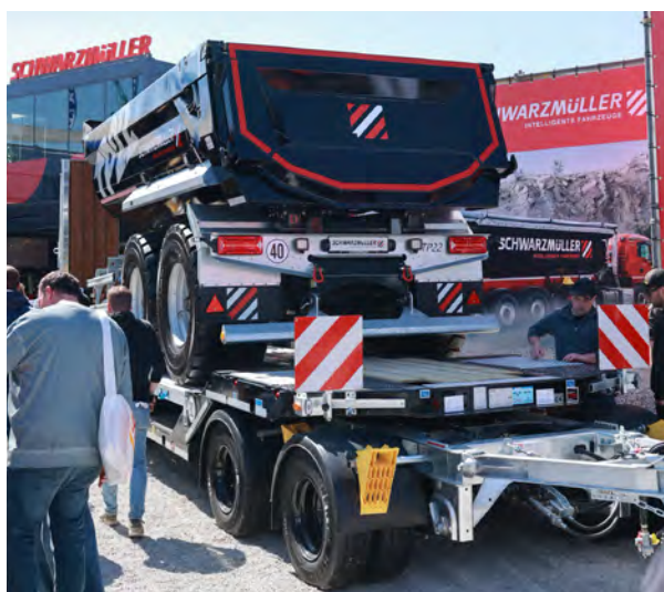
Grupa Schwaermüller przedstawiła między innymi lekką naczepę samowyładowczą z ramą i skrzynią wykonaną z aluminium, przyczepę do transportu maszyn budowlanych oraz przyczepę samowyładowczą Hüffermann przeznaczoną do prac w trudnym terenie z ciągnikiem rolniczym.
