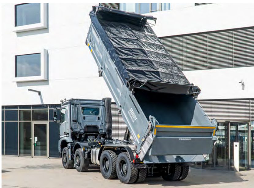
Z myślą o podwoziach czteroosiowych zaprojektowano zabudowę tylnozypową TRIGENIUS D421. Takie rozwiązanie umożliwia uzyskanie większej ładowności oraz objętości skrzyni ładunkowej, co przekłada się na wyższą efektywność.
