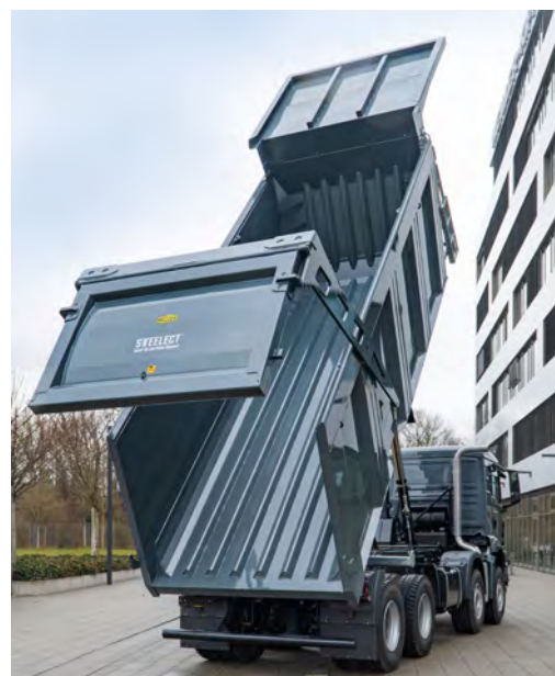
Wywrotka tylnozypowa MAXTREME z kanciastym kształtem skrzyni i mechaniczną klapą.
