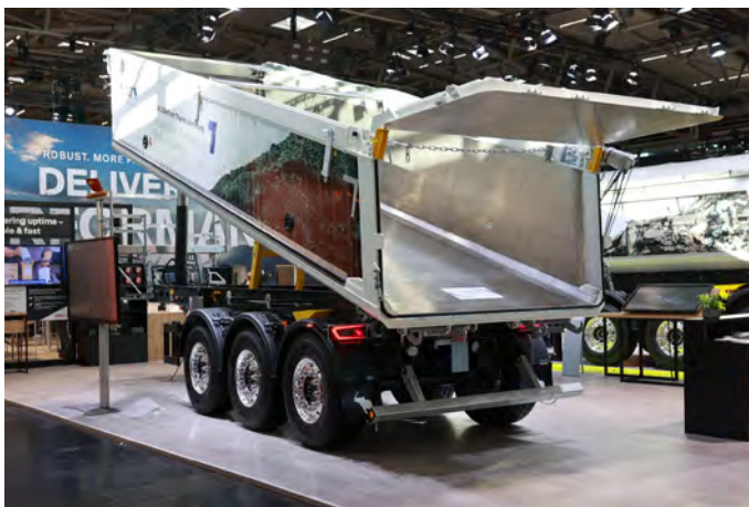
Lekka naczepa Schmitz typu S.KI Light z izolowaną skrzynią, przeznaczona do transportu asfaltu.
