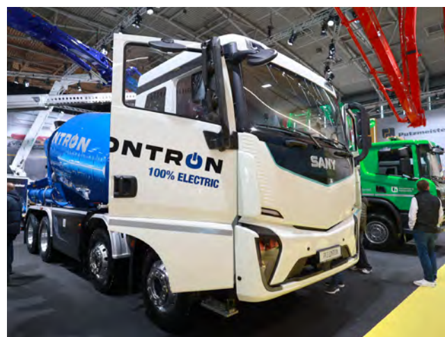
Betonomieszarka Putzmeister na podwoziu SANY. Catość elektryczna, zasilana z akumulatorów trakcyjnych pojazdu o pojemności 350 kWh. Producent podaje, że taka ilość energii wystarcza na 8 godzin pracy.
