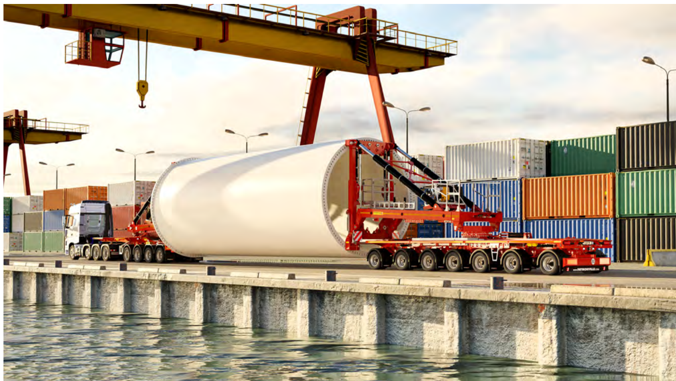
Adaptory Faymonville umożliwiają transport elementów kolumny elektrowni wiatrowej o średnicy wewnętrznej od 2650 do 5400 mm, a po wyposażeniu w dodatkowe akcesoria do 6300 mm.
