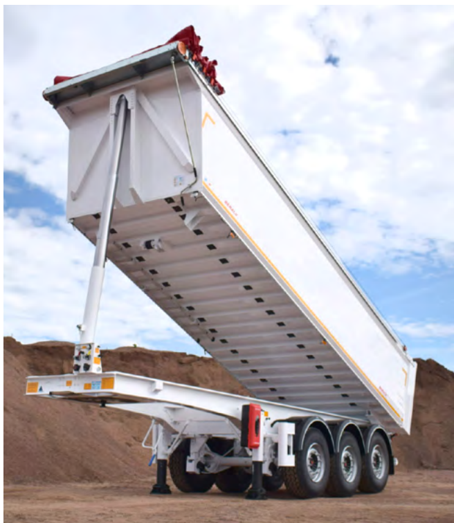
Naczepa samowyładowcza Benalu przystosowana konstrukcyjnie do pracy w budownictwie. Co ciekawe, zarówno skrzynia, jak i rama są z aluminium.
