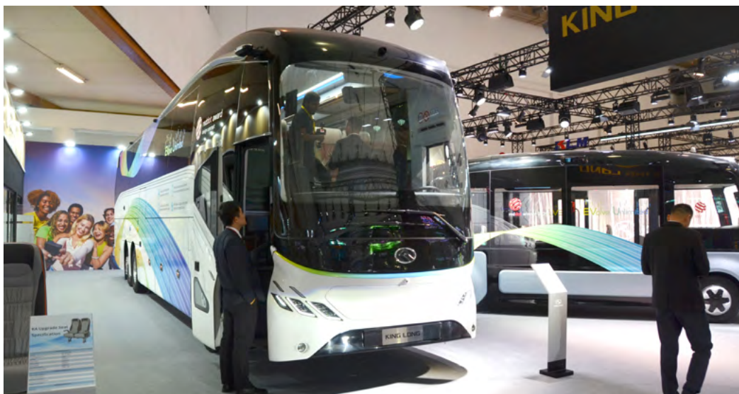
Chińczycy zdobyli już spore doświadczenie w produkcji elektrycznych autobusów na dłuższe dystanse. King Long MC13E ma baterie o pojemności 704 kWh, które zapewniają zasięg do 650 km.
