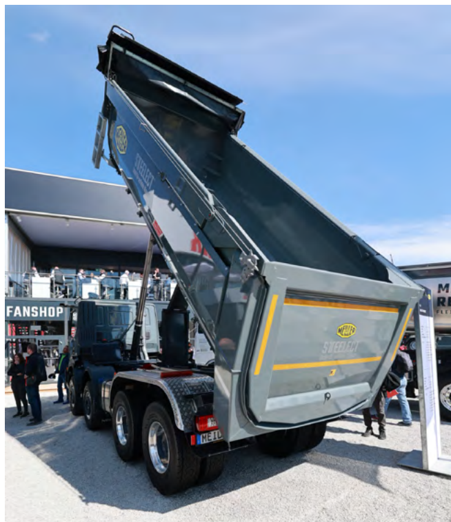
Producenci pojazdów samowyładowczych zwracają uwagę, że najważniejsze jest przystosowanie pojazdu do typu ładunku i warunków eksploatacji. Meiller-Kipper oferuje wywrotki stalowe i aluminiowe, a doświadczenie konstruktorów pozwala optymalizować je pod kątem niskiej masy i drobnych rozwiązań podnoszących funkcjonalność i niezawodność.
