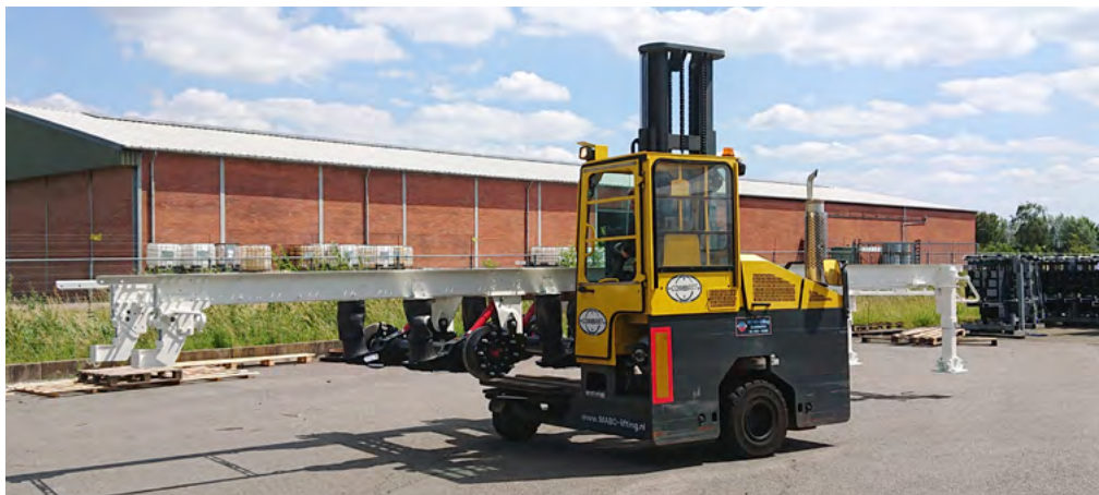
Ogumienie wózka należy dostosować do podłoża oraz charakteru pracy.
