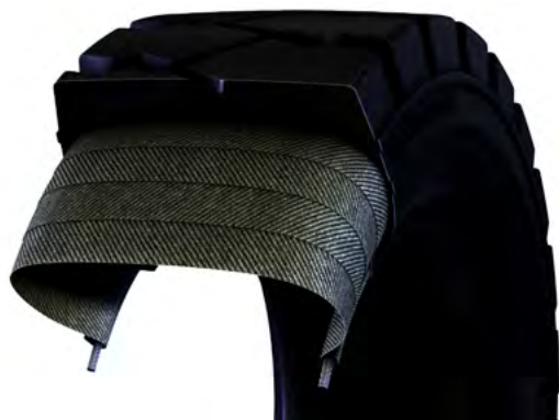
Opona diagonalna z krzyżowo ułożonym kordem jest stosunkowo sztywna, stabilna i odporna na uszkodzenie boku. Jest również tańsza niż radialna.
