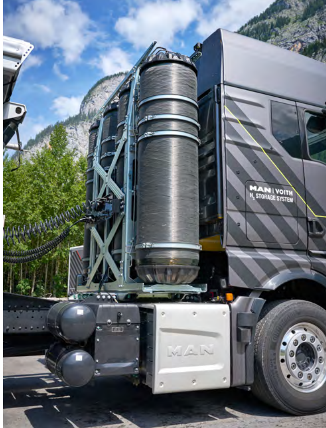
Zbiorniki ze sprężonym wodorem zastosowane w MAN-ie hTGX mieszczą 56 kg wodoru pod ciśnieniem 700 barów. Taka ilość gazu wystarcza do pokonania maksymalnie 600 km.
