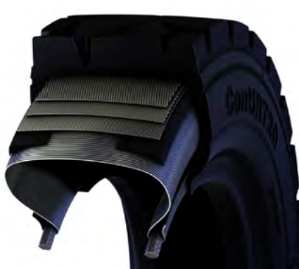
Promieniście ułożony kord oraz opasanie wzmocniające czło to cechy opony radialnej. Do jej zalet należy dobra przyczepność w zróżnicowanych warunkach, wysoka zdolność tłumienia nierówności oraz relatywnie niskie opory toczenia.
