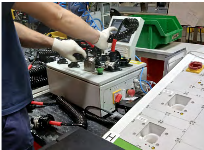
Stanowisko kontroli złącza elektrycznego. Mimo przestrzegania norm i procedur, i tak 100% produkcji złączy przechodzi kontrole fabryczne.
