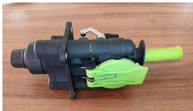
Prototyp wtyczka-gniazdo do złącza C15, które już umożliwia przesyłanie 10 GB sygnału między ciężarówką a naczepą.
