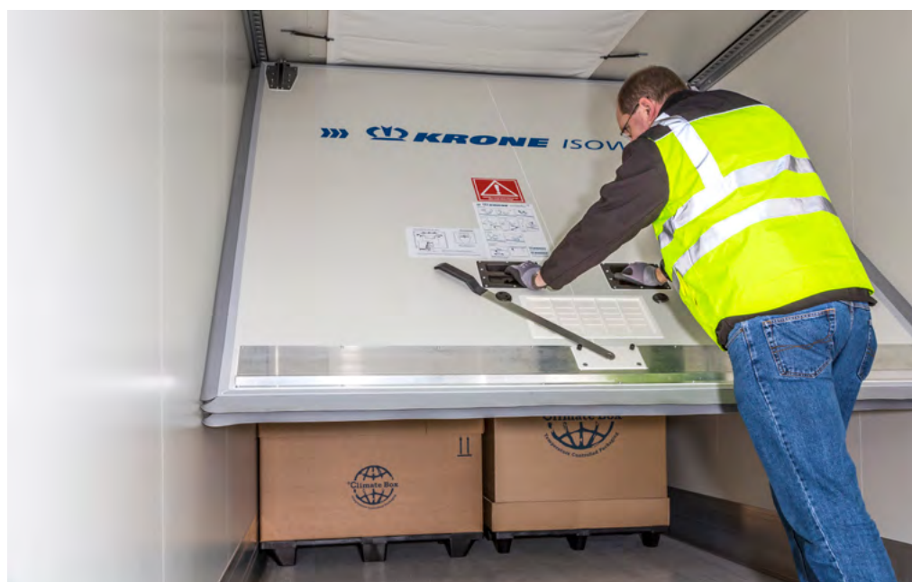
Podział ładowni oraz zastosowanie agregatu wielotemperaturowego umożliwiają przewóz produktów potrzebujących odmiennych warunków.
