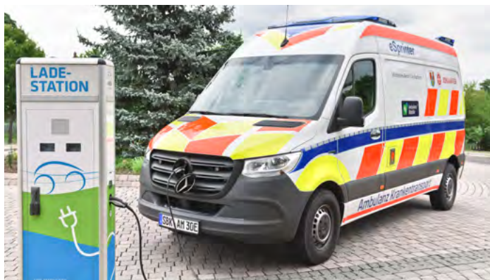
Elektryczny eSprinter pokazany po raz pierwszy na targach RETTmobil w 2021 roku ma krótki, bo zaledwie 120-kilometry zasięg, za to baterie można naładować od 10 do 80% w 20 minut.
