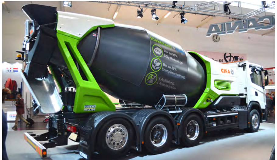
Gaz i prąd razem. Scania zasilana CNG z napędzaną elektrycznie betonomieszarką CIFA.
