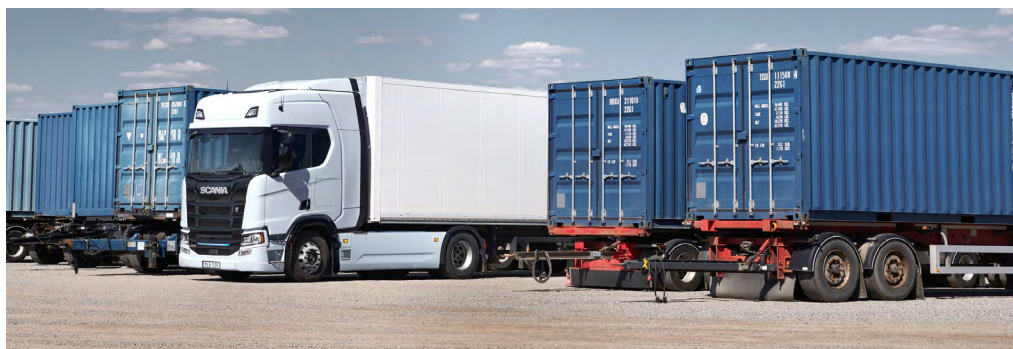
Scania rozpoczęła sprzedaż elektrycznych pojazdów od modelu 25P, ale szykuje się do wprowadzenia na rynek 45R. Maksymalny zasięg 40-tonowego zestawu to w tym przypadku 350 km. Baterie można ładować mocą do 375 kW.
