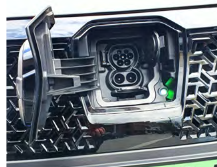
W standardzie na pokładzie Townstara zamontowano ładowarkę o mocy ładowania 11 kW, ale można zamówić też 22-kilowatową, a także możliwość szybkiego ładowania prądem stałym do mocy 80 kW. Rodzaj dostępnej ładowarki Nissan powiązał z wersją wyposażenia.
