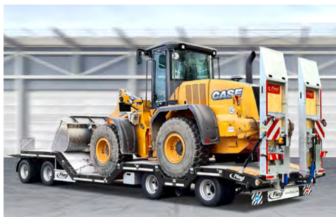
Przyczepa niskopodłogowa VTS 400 z zagłębieniami na kota. Niżej ułożona maszyna obniża środek ciężkości oraz wysokość całkowitą załadowanego zestawu.
