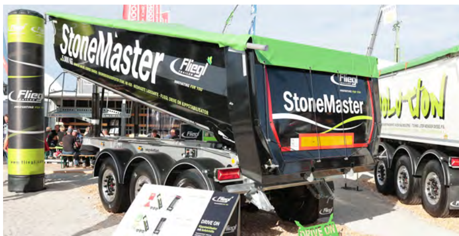
Naczepa wywrotki Fliegl StoneMaster z systemem Drive On stabilizującym rozładunek.
