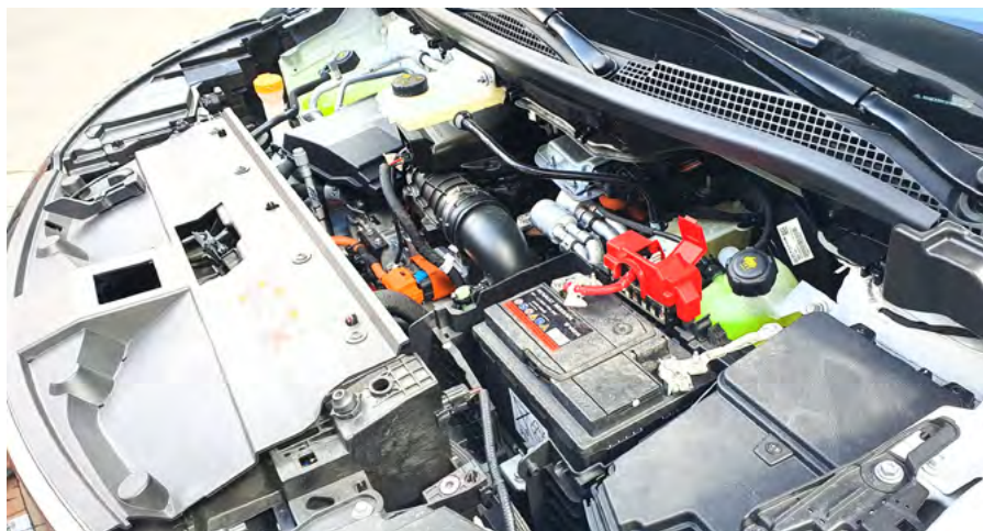
Osprzęt elektrycznego układu napędowego umieszczono pod maską. Baterie natomiast są zamontowane pod podłogą.
