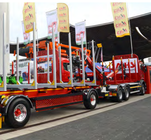
Leśny zestaw do transportu drewna MHS Mikulski Serwis złożony z trzyosiovej ciężarówki oraz dwuosiovej przyczepy.
