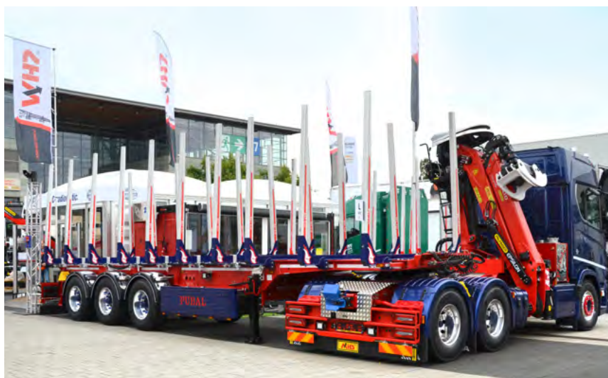
Ciężki ciągnik z żurawiem i naczepą z łąwą i kłonicami. Może transportować zarówno drewno stosowe, jak i dtużycę.
