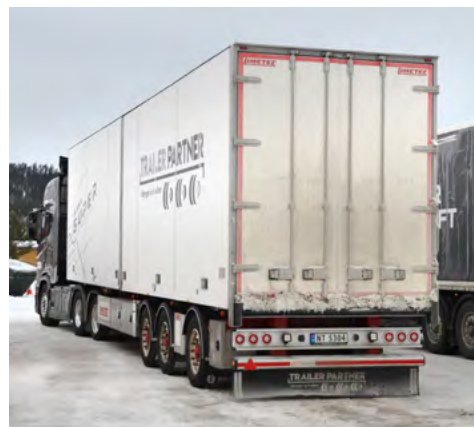
Ciągnik 560R A6x2NB z sześciocyndrowym silnikiem DC13. Naczepa z zabudową fińskiej firmy Limetec ma charakterystyczną dla pojazdów skandynawskich lewą ścianę otwieraną na całą szerokość.
