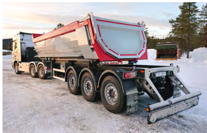
Ciągnik Scania 660R A6x4HB z odłączaną i unoszoną osią napędową i pakietem XT. Naczepa samowyładowcza Istral ma osie w charakterystyczny sposób przesunięte do tyłu. Za kabiną widoczny pionowy zbiornik oleju hydraulicznego.
