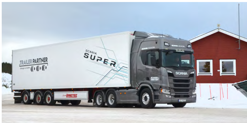
Ciągnik 560R A6x2NB z sześciocyndrowym silnikiem DC13. Naczepa z zabudową fińskiej firmy Limetec ma charakterystyczną dla pojazdów skandynawskich lewą ścianę otwieraną na całą szerokość.
