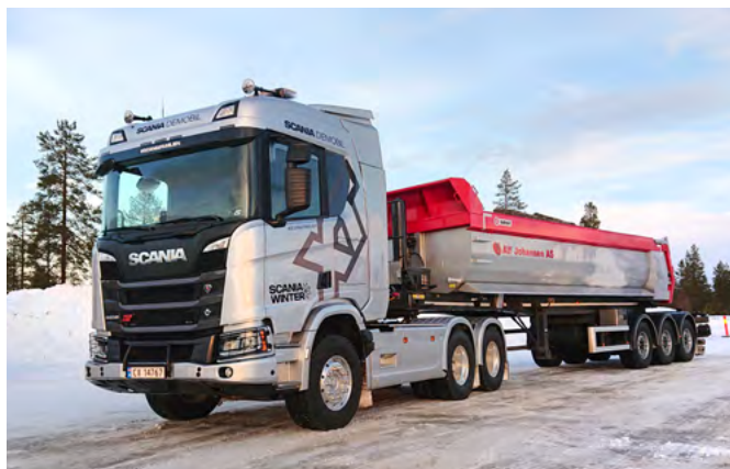
Ciągnik Scania 660R A6x4HB z odłączaną i unoszoną osią napędową i pakietem XT. Naczepa samowyładowcza Istral ma osie w charakterystyczny sposób przesunięte do tyłu. Za kabiną widoczny pionowy zbiornik oleju hydraulicznego.
