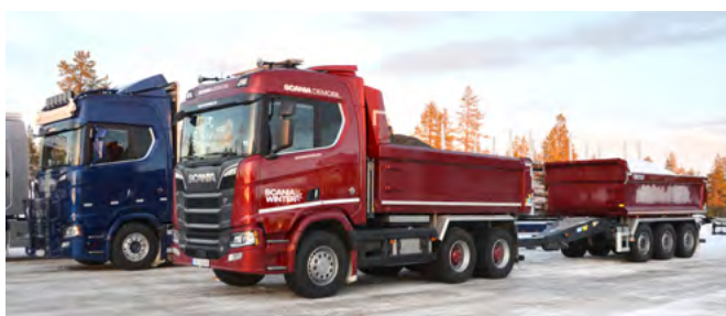
Praktyczny przykład „reguły mostu” w wykonaniu norweskim. Scania 590R B6x4HZ z kabiną sypialną i silnikiem V8 holuje przyczepę na długim dyszlu, który zwiększa odległość między ostatnią osią ciężarówki, a pierwszą przyczepę. Zabudowę wykonała firma Istrail.
