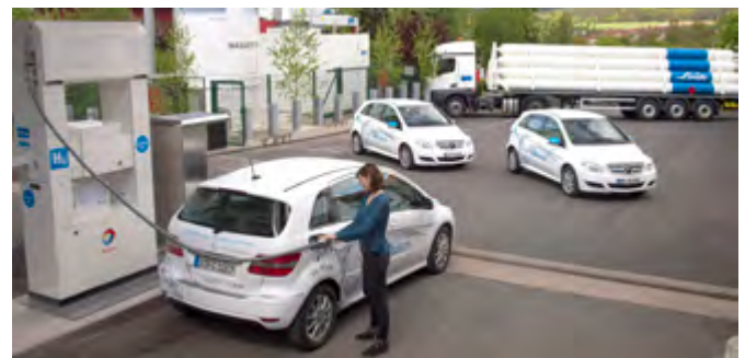
Pierwsza w Niemczech autostradowa stacja tankowania wodoru została uruchomiona w 2015 roku przy drodze A3 w Geiselwind między Würzburgiem i Norymbergą. Uruchomili ją wspólnie Daimler, Linde i Total. Na drugim planie widoczny jest zestaw ze zbiornikami rurowymi do transportu sprężonego wodoru.
