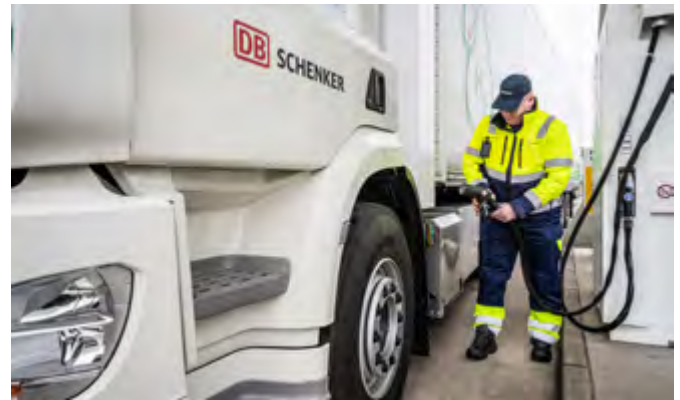
Tankowanie wodoru nie jest trudniejsze niż tankowanie innego gazu. W przypadku pojazdu użytkowego zajmuje kilkanaście minut.
