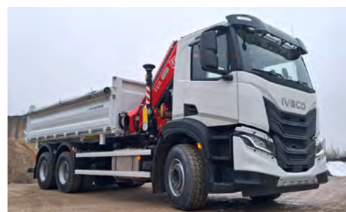
Wszechstronna wywrotka trójstronna KH-Kipper z żurawiem za kabiną, przydatna np. w pracach remontowo-budowlanych. Podwozie X-Way z 460-konnym silnikiem. Dzięki podwyższonemu zawieszeniu (tzw. setup) ON+, pojazd ma większy prześwit i jest mniej narażony na uszkodzenie w lekkim terenie.
