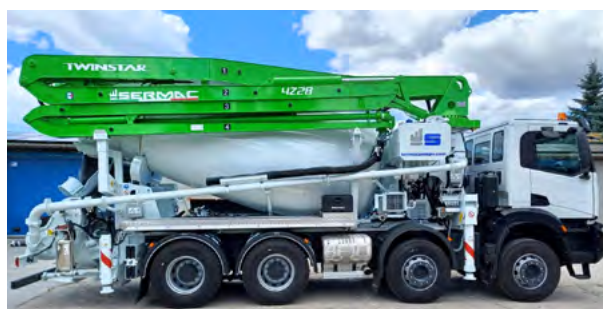
Betonomieszarka z pompą do betonu Sermac Twinstar 4Z28 na czteroosiowym podwoziu T-Way o wysokiej nośności.
