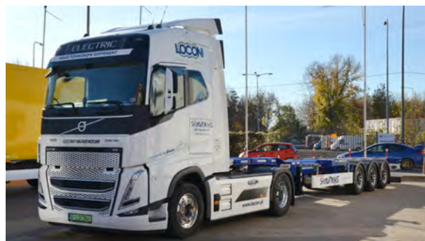
Volvo FH electric to kolejny przykład elektrycznego ciągnika, który znalazł zastosowanie w przewożeniu kontenerów na krótkich dystansach w ramach transportu intermodalnego.
