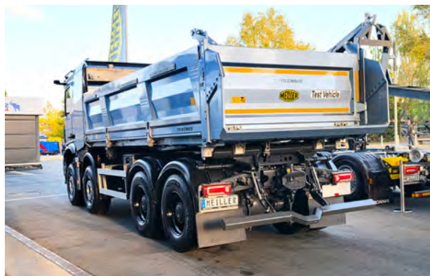
Wywrotka trójstronna Trigenius D428 na czteroosiowym elektrycznym podwoziu Mercedes wskazywała możliwy kierunek rozwoju pojazdów do dystrybucji materiałów budowlanych.
