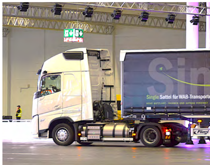
Nietypowa, jednoosiowa naczepa Fliegl do transportu nadwozi wymiennych powstała z myślą o logistyce „ostatniej mili”.
