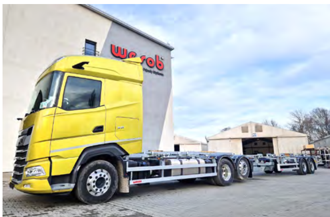
DAF z zabudową i przyczepą Wesob do transportu nadwozi wymiennych C745 i C782 o wysokości odstawczej od 1120 do 1320 mm.
