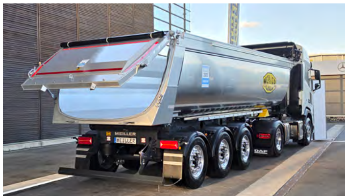
Naczepa Grandload przygotowana do pracy z rozścielaczem asfaltu. Skrzynia o pojemności 25 m 3 wykonana jest ze stali trudnościelnej HBW 450.
