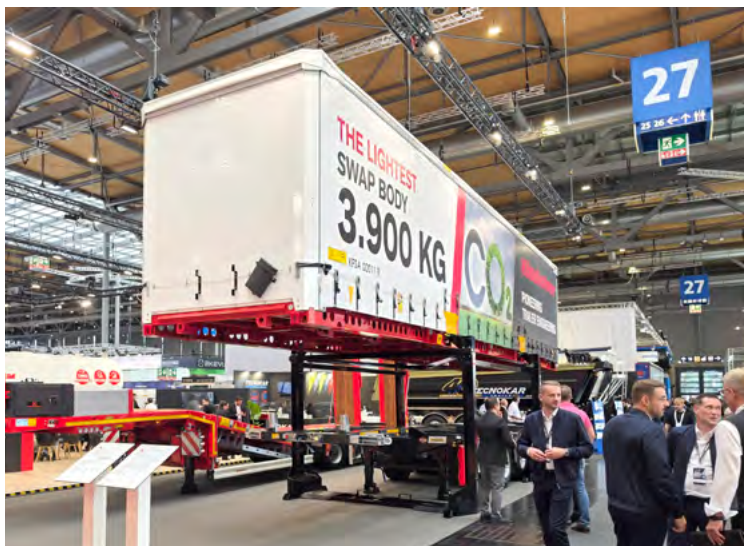
Nadwozie wymienne Kässbohrer przeznaczone do transportu na naczepie podkontenerowej. Nadwozia tej wielkości są powszechnie stosowane w logistyce branży motoryzacyjnej.
