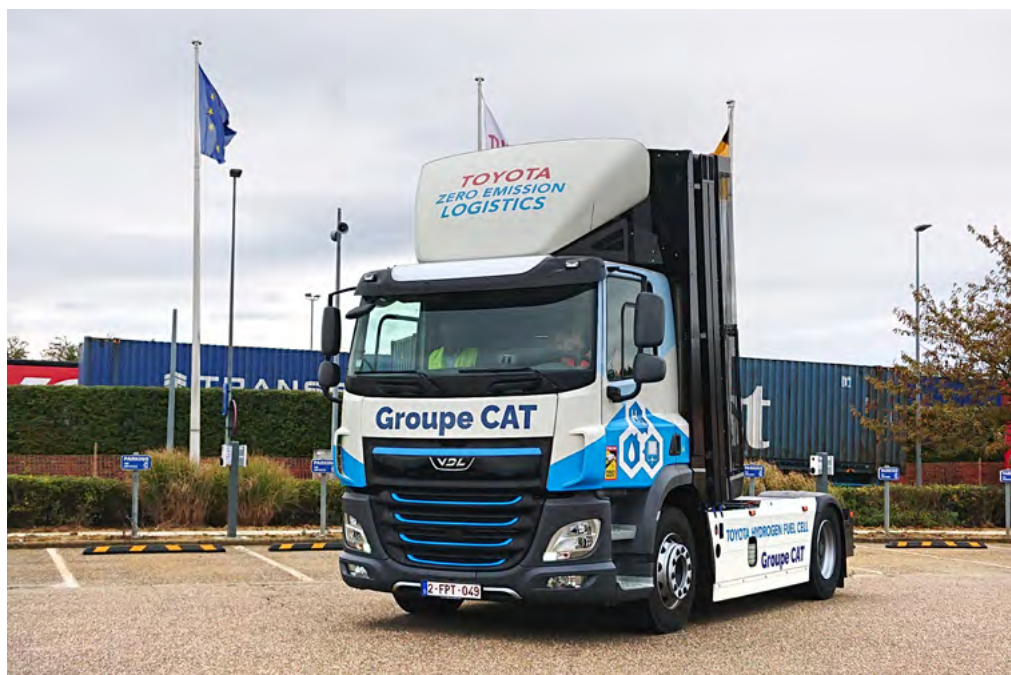
Ciągnik VDL powstał na bazie DAF-a CF. Krótka, niska kabina jest stosunkowo lekka, a z tyłu zostało miejsce na zbiorniki wodoru.
