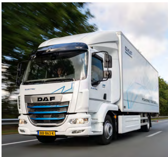
Testowy XB 190E wyposażony jest w dwa zestawy akumulatorów typu C-Pack o łącznej pojemności 210 kWh. W praktyce daje mu to teoretyczny zasięg od 200 do 250 km. Pojazd wyposażono w przystawkę e-PTO (600V).
