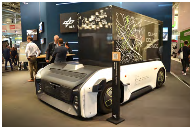
Autonomiczny pojazd U-Shift został opracowany przez DLR, czyli Niemieckie Centrum Aeronautyki (niem. Deutsche Zentrum für Luft- und Raumfahrt). Składa się z podwozia w kształcie litry „U” (stąd nazwa) oraz wymiennej zabudowy. DLR przewiduje, że U-Shift będzie mógł elastycznie dostosowywać się do zadań, transportując ludzi bądź ładunki.
