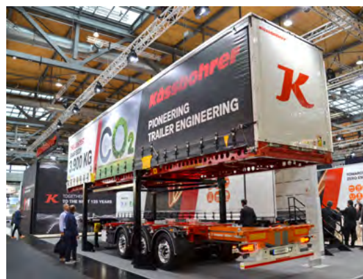
Lekkie, 45-stopowe nadwozie wymienne Kässbohrer K.SWAU CL i naczepa podkontenerowa K.SHAU AVMH z ramą, której centralnym elementem jest biegnący wzdłuż duży, ośmiokątny profil. Całość ukierunkowana na zmniejszenie masy własnej przy zachowaniu wysokiej wytrzymałości.
