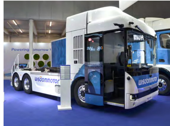
Wisdommotor T25FC110 z nisko zawieszoną kabiną i zabudową hakową. Ma wodorowe ogniwo Ballard o mocy 110 kW i baterie CATL o pojemności 59 kWh.
