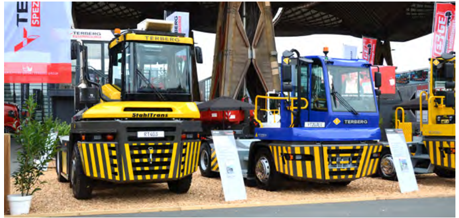
Ciągniki terminalowe Terberg. Z lewej spalinowy RT403 z silnikiem wysokoprężnym Volvo, z prawej elektryczny YT203EV z silnikiem centralnym ZF CeTrax.
